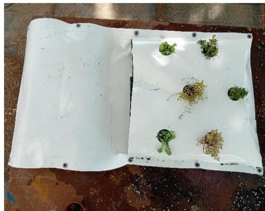
Figura 25 Módulo mBIGWTray de ensaio.
