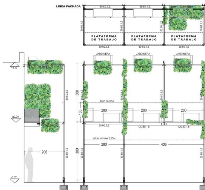
FAVE-1 SUBESTRUCTURA CON PARASOLES HORIZONTALES Y VERTICALES CON MACETAS Y TREPADORAS
