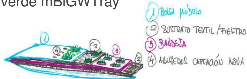
Solución integrable para techos de baja capacidad de carga.
