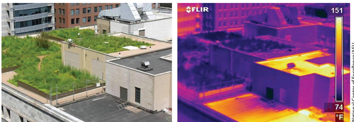
Figura 1. Comparación entre las temperaturas superficiales de una cubierta verde y una cubierta de hormigón (U.S.EPA, 2008).
