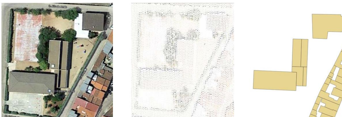
Figura 1: a) Ortofoto, b) Nube de puntos LiDAR, c) Geometría DG Catastro del edificio objeto de estudio
