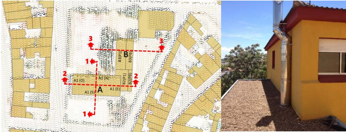
Figura 3: a) Mapa de nube de puntos LiDAR superpuesto con mapa catastral donde se muestran las secciones de los módulos A y B para determinar la inclinación de las cubiertas. b) Imagen del edificio tomada in-situ
